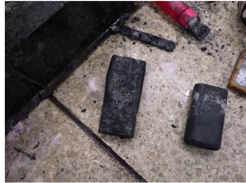
写真2 モバイルバッテリーの焼損状況
