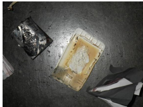
写真6 モバイルバッテリーの焼損状況
