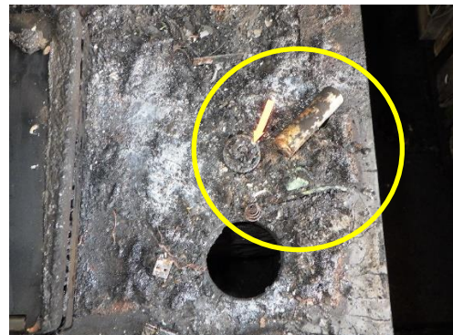
写真8 携帯型扇風機の焼損状況
