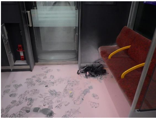
写真1 電車内の焼損状況（復元）
